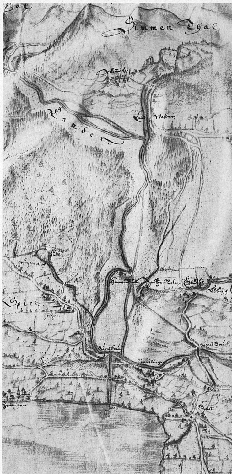
La prima grande opera correttiva eseguita in Svizzera fu la deviazione del corso della Kander, la quale, in origine, si gettava nell'Aare e, dopo la costruzione di un canale – intervento davvero audace e senza precedenti nel regno della Natura – sfocia, invece, nel lago di Thun. A destra, particolare della carta disegnata nel 1710 per il Governo bernese da Samuel Bodmer, ideatore dei lavori. È visibile il canale tagliato nella collina di Strättligen
