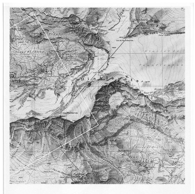
Die neue Landeskarte im Massstab 1:25000. Relieftöne machen das Kartenbild leichter lesbar; für den Druck werden 8 Farben verwendet. Der eingezeichnete Ausschnitt entspricht der umseitigen Luftaufnahme. Reproduziert mit Bewilligung der Eidg. Landestopographie vom 2. August 1973
