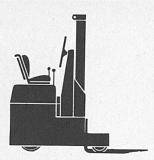
SAXBY-MINIWAR Kleinster Elektro-Vorschub-Gabelstapler Tragkraft 1 t Hub 2600-3400 mm ab Fr. 15 800. + elektr. Ausrüstung
