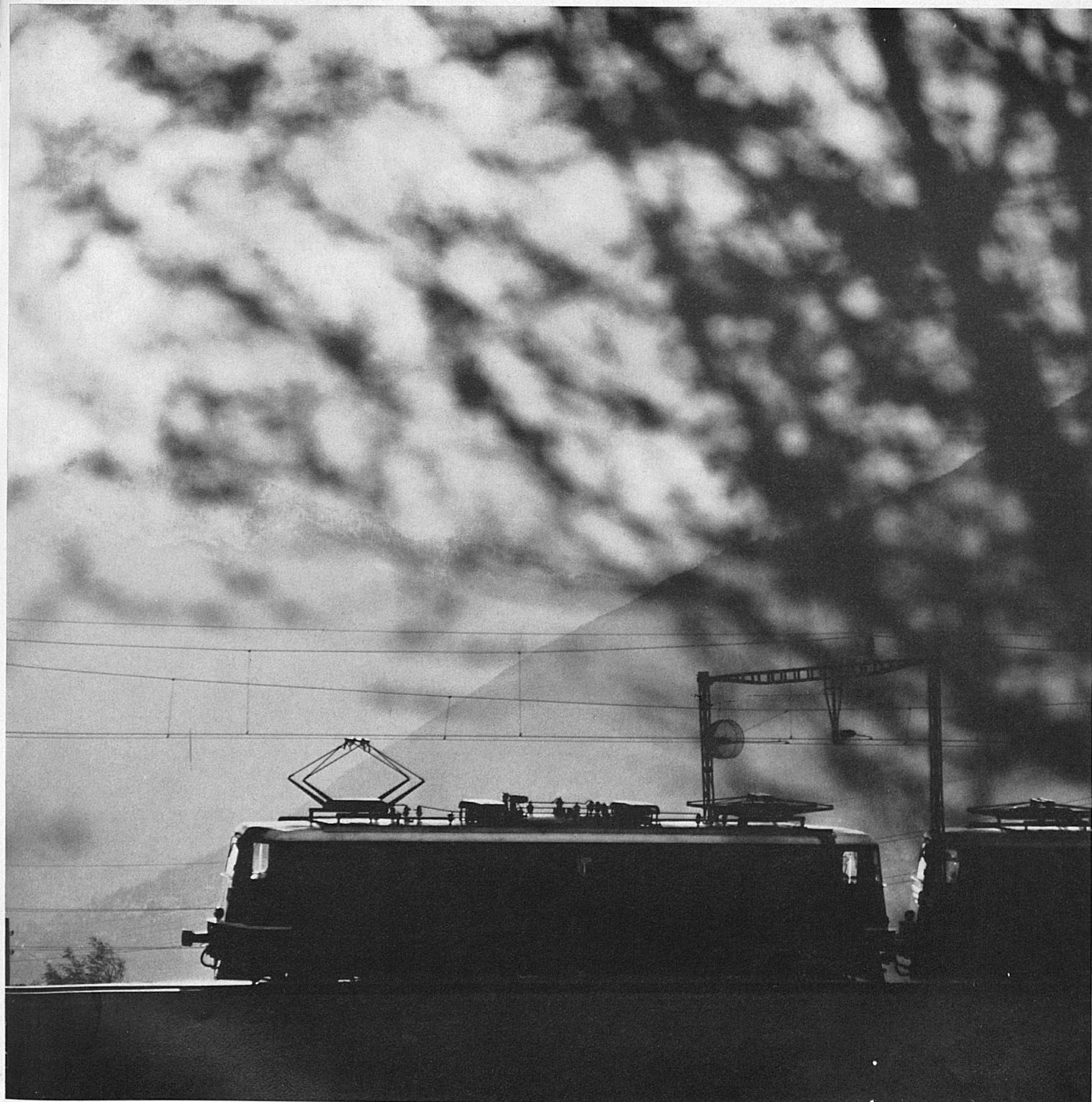
Ae6/6-Lokomotiven an der steilen Monte-Ceneri-Rampe der Gotthardlinie. Moderne elektrische Lokomotiven können so miteinander verbunden werden, dass für zwei Maschinen ein einziger Lokomotivführer genügt. Photo Studer
