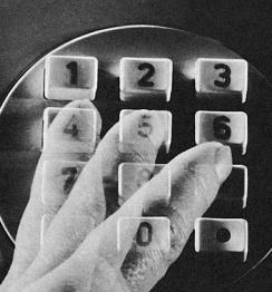
Unsere Tastenwahleinrichtung haben wir eigens für die Haustelephonzentrale ESK 8000 entwickelt. Elektronik und Edelmetall-Schnellkontakt-(ESK) Relais arbeiten mit hoher Geschwindigkeit Hand in Hand.
