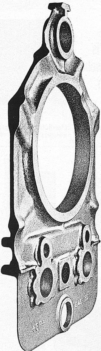
Diese Endwand zu einem Dieselmotor mit einer Leistung von 2400 PS wiegt 84 kg.
