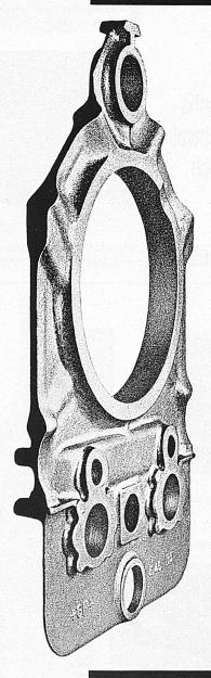
Diese Endwand zu einem Dieselmotor mit einer Leistung von 2400 PS wiegt 84 kg. Die Herstellung eines solchen Gussstückes
