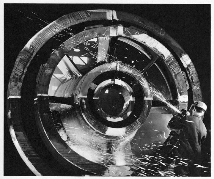
Abgasgehäusering aus hitzebeständigem Stahlguß für eine 20 000-kW-Sulzer-Gasturbine
