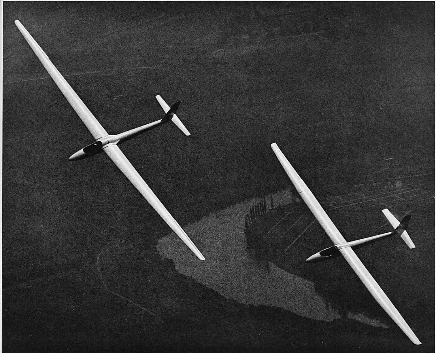
Segelflugzeuge schweizerischer Konstruktion, ein Bild der Eleganz. Es zeigt die Typen Elfe Standard mit einer Spannweite von 15 Metern und die Super-Elfe mit einer Spannweite von 17,5 Metern. Photo Bruell
