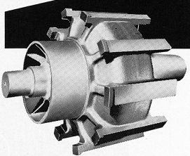
Rotor, in zwei Teilen gegossen und zusammengeschweisst, Gewicht 380 kg 600 Tonnen oder 30 Güterwagen...
