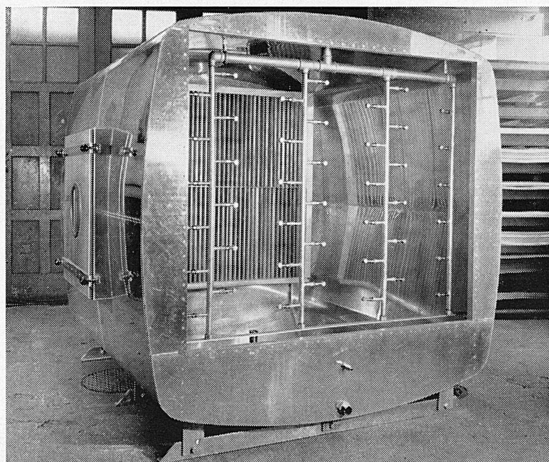
Luftwäscher und Befeuchter aus Aluminium geschweisst
