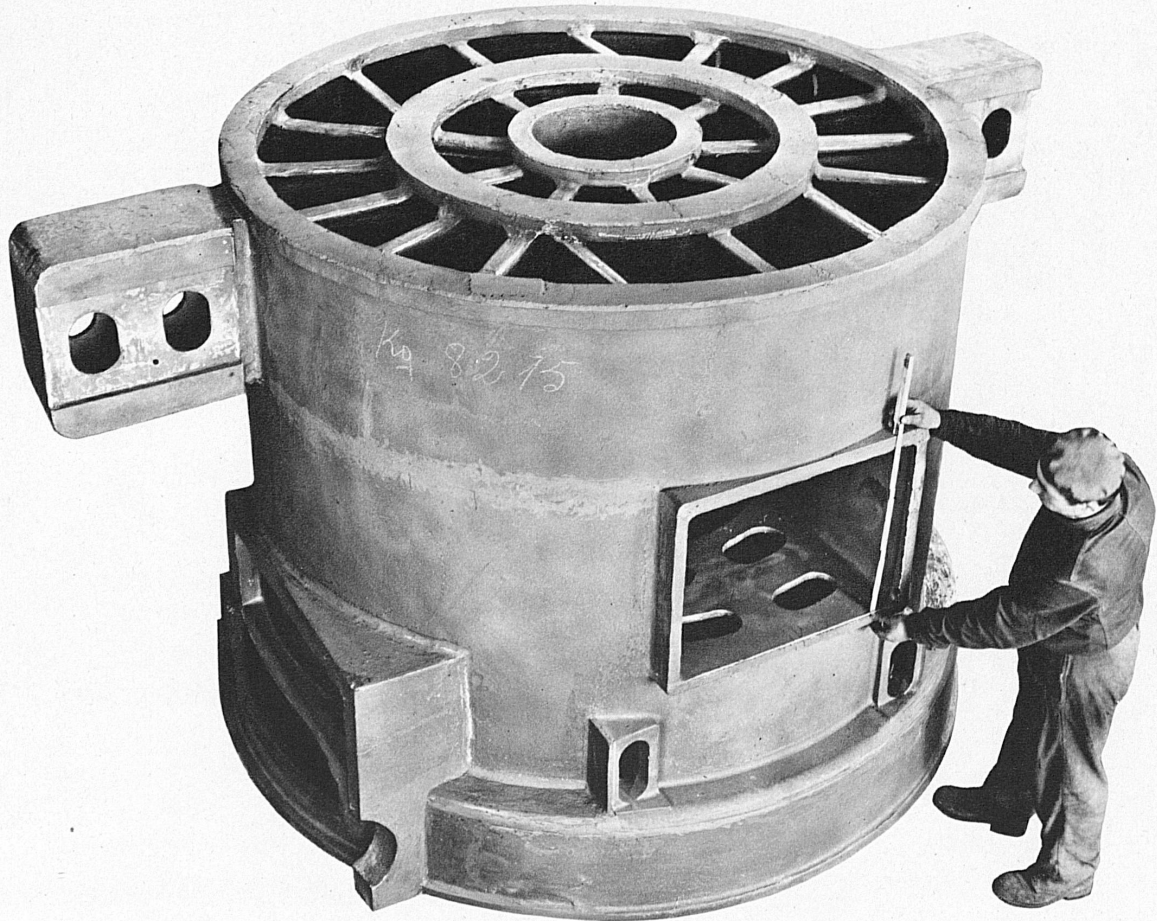
Teilradtisch einer Werkzeugmaschine aus Grauguß im Gewicht von 8 t
