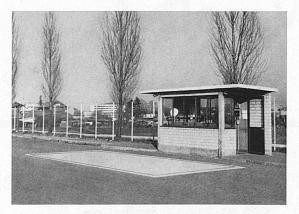
Abbildung: Fuhrwerkswaage 40 000 kg Brückengrösse 10×3,2 m Laufgewichtsbalken mit Messkopf kombiniert
