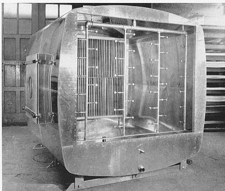
Luftwäscher und Befeuchter aus Aluminium geschweißt
