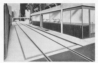
Auto- und Eisenbahnwaagen von 20 bis 200 t Tragkraft; Brücken 7 bis 20 m lang, aus armiertem Beton; torsionsfreies Hebelwerk, verstell- und auswechselbare Schneiden; Gewichtsanzeige mittels Laufgewichtsbalkens oder vollautomatisch mit Zeigerkopf oder Registrierdruckwerk, (System Schenck)
