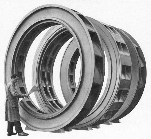
Die Leiträder der größten Speicherpumpen der Welt wurden bei Gebrüder Sulzer gegossen. Die entsprechende Anlage besteht aus vier Pumpen zu je 110000 PS und befindet sich in Ffestiniog (Wales). Stückgewicht:
