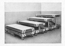
Fahrbare hydraulische Hebetische zur Vereinfachung des Transportes von Blechen von Maschine zu Maschine. Hubkraft 10 000 kg, Tischgröße  $1\times2,5$  m
