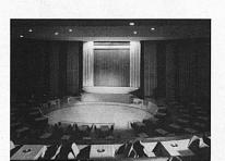
Hydraulische Attraktions- und Orchesterbühnen in einem Kursaal. Größe der Bühnen: oval  $10\times13$  m und  $\varnothing$  9,6 m Hubhöhen etwa 4,9 m, Hubkraft 10 000 kg
