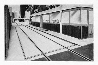
Auto- und Eisenbahnwaagen von 20 bis 200 t Tragkraft; Brücken 7 bis 20 m lang, aus armiertem Beton; torsionsfreies Hebelwerk, verstell- und auswechselbare Schneiden; Gewichtsanzeige mittels Laufgewichtsbalkens oder vollautomatisch mit Zeigerkopf oder Registrierdruckwerk, System Schenck
