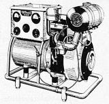
igen usw. eistung 5 kW., konstante Spannung 220,380 V durch undierung ohne Erregermaschine. tröstet mit 4-Takt-MAG-Motor Typ 1040-SRL für Benzin-trolbetrieb. Dauerleistung des Motors 8-9 PS.
