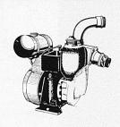
Bau- und Bewässerungspumpe, ausgerüstet mit 4-Takt-MAG-Motor Typ 1940-SRL für Benzin- und Petrolbetrieb. Dauerleistung des Motors 8-9 PS. Die Pumpe schöpft bei 15 m manometrischer Forderhöhe 700 Liter pro Minute. Sie ist selbstansaugend und leicht transportabet.
