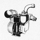
Pompe d'épuisement et d'irrigation, transportable, à succion automatique. 700 l/min. à 15 m. de pression manométrique; équipée d'un moteur MAG 4-temps type 1040-SRL pour marche à l'essence ou au pétrole. Puissance continue du moteur 8-9 CH.
