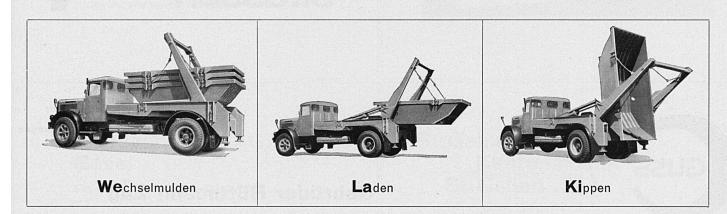
Ein Lastwagen arbeitet mit 10 bis 20 Behältern und bietet dadurch
