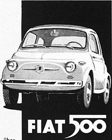
2 Zyl. 4 Taktmotor • Luftkühlung • 4 Ganggetriebe • 4 Plätze • über
