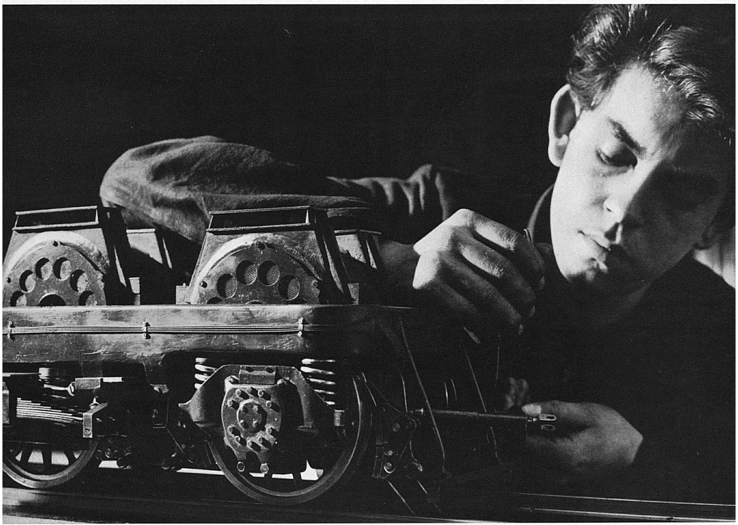
Die Bremsklötzte werden am Drehgestell montiert.
