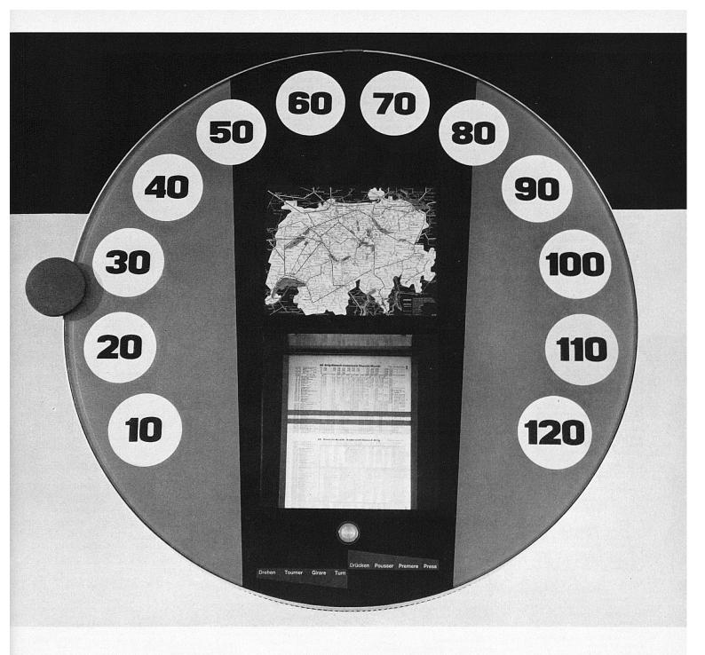
Nel III Circondario, le Ferrovie federali tendono attualmente a presentare ai viaggiatori l'orario sotto forma di film. La nostra fotografia mostra l'apparecchio di lettura del film messo in prova alla stazione di Zurigo.
