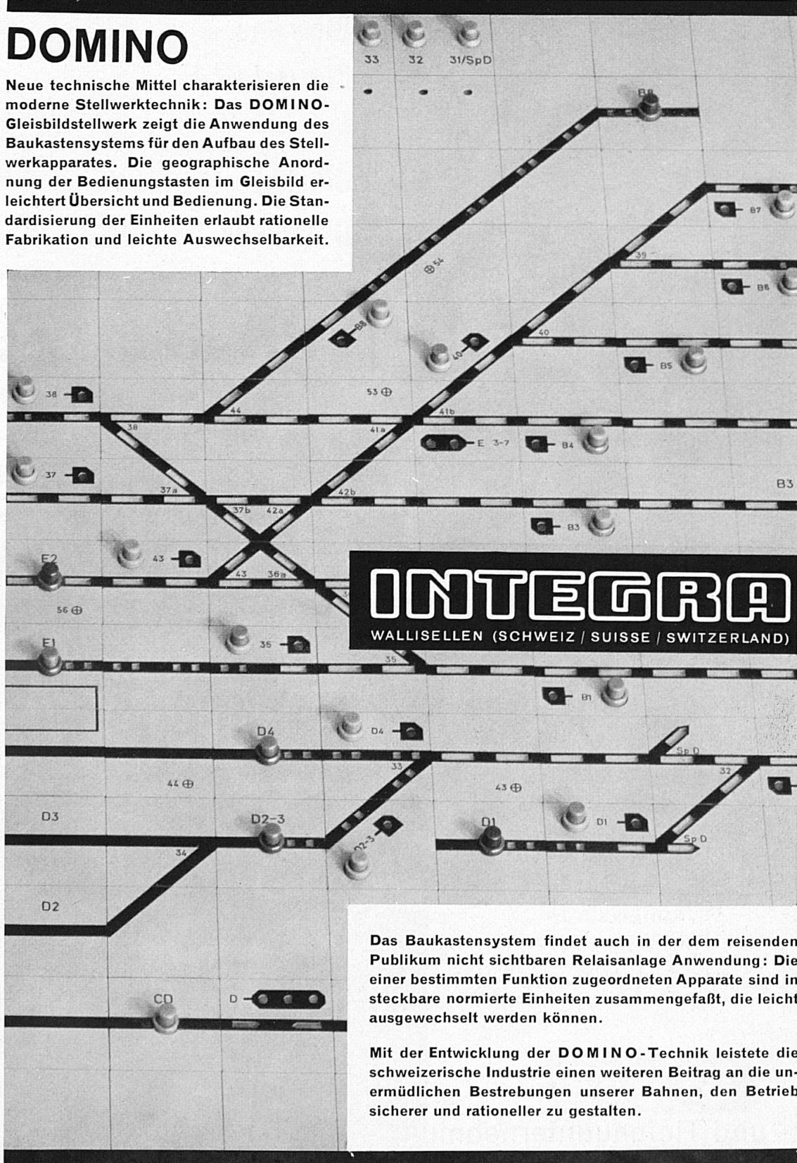
**Das Baukastensystem findet auch in der dem reisenden Publikum nicht sichtbaren Relaisanlage Anwendung: Die einer bestimmten Funktion zugeordneten Apparate sind in steckbare normierte Einheiten zusammengefaßt, die leicht ausgetauscht werden können.**
