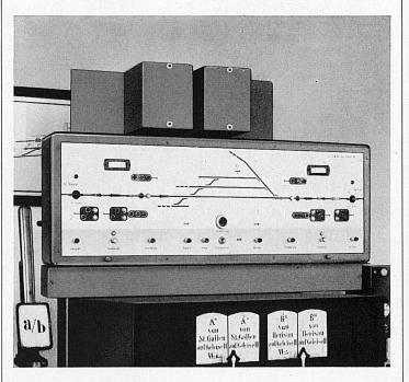
Installations de sécurité pour chemins de fer Tableau de voies pour bloc
