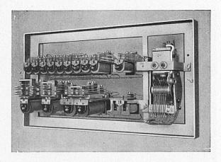
Steuereinrichtung zu einspurigem Streckenblock
