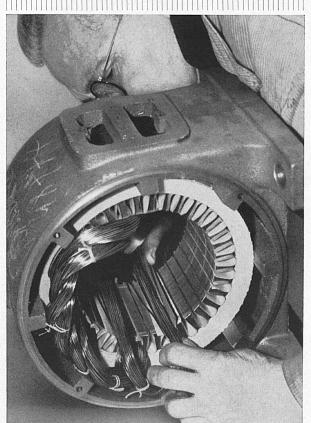
Wicklungsdrähte für den Motorenbau
