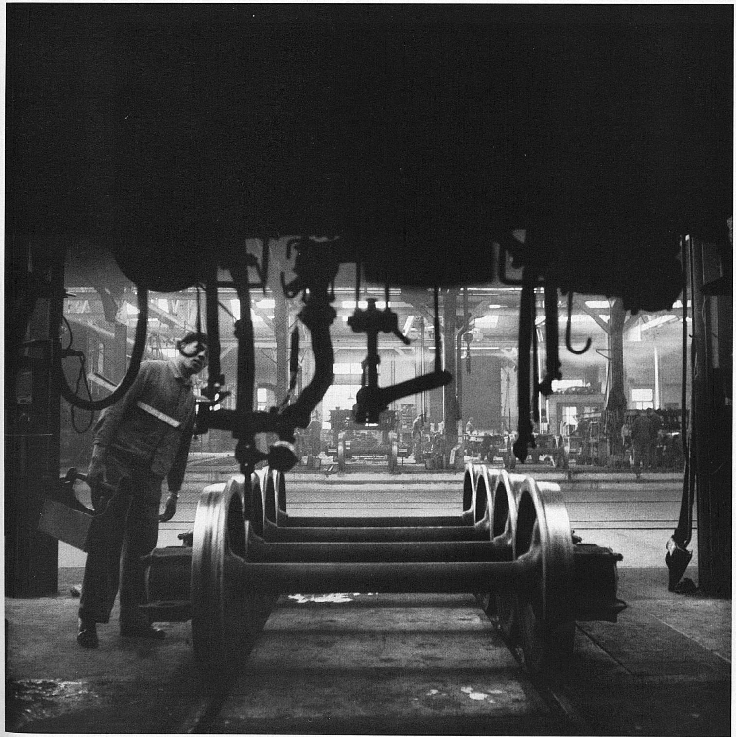
Die aufgearbeiteten Radsätze stehen für den Einbau unter den Wagen bereit. — Réparés, les essieux montés sont prêts à être fixés aux wagons. — La coppia di ruote rifinita è pronta per essere applicata alla carrozza. — The processed wheels are ready to be mounted beneath the carriages. — Los pares de ruedas se hallan preparados para ser montados bajo los vagones.
