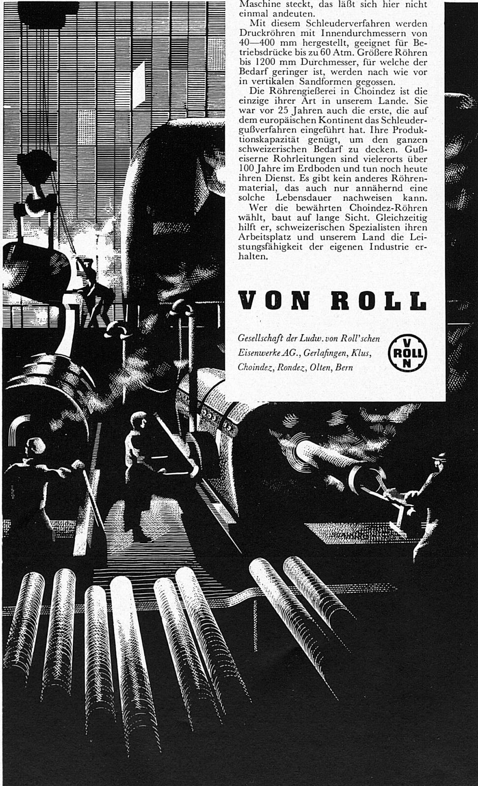
**D**as in der engen Juraschlucht fast gespenstisch wirkende Choindez ist in mancher Hinsicht eigenartig. Nicht nur steht dort Tag und Nacht der einzige Hochofen der Schweiz im Betrieb — das Werk verfügt auch über eine Zentrifugal-Gießerei, in welcher Röhren in wenigen Sekunden «geschleudert» werden, statt daß man sie umständlich im Sand gießen muß.
