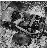
Chaque aiguille est actionnée par un moteur électrique commandé a distance. Jede Weiche wird durch einen elektrischen, ferngesteuerten Motor geschaltet. Photo Presse-Diffusion, Lausanne
