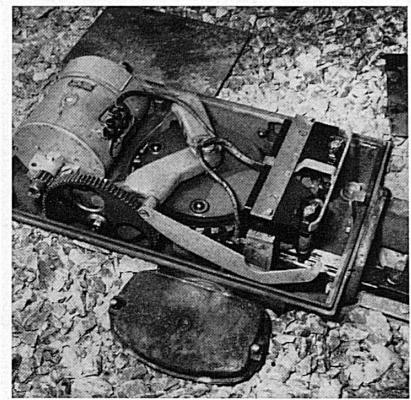
Chaque aiguille est actionnée par un moteur électrique commandé à distance. Jede Weiche wird durch einen elektrischen, ferngesteuerten Motor geschaltet.
