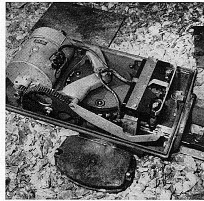
Chaque aiguille est actionnée par un moteur électrique commandé à distance. Jede Weiche wird durch einen elektrischen, ferngesteuerten Motor geschaltet. Photo Presse-Diffusion, Lausanne
