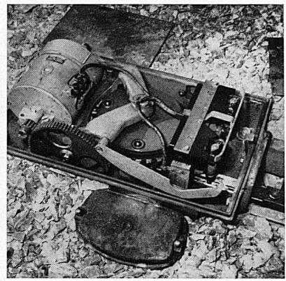
Chaque aiguille est actionnée par un moteur électrique commandé à distance. Jede Weiche wird durch einen elektrischen, ferngesteuerten Motor geschaltet.
