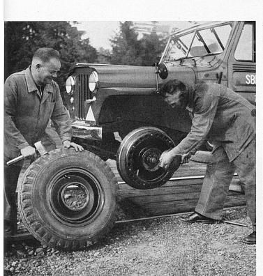
Oben: Mit ein paar Handgriffen werden die Pneuräder mit den Schienenrädern vertauscht.
