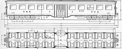
Oben: Die neueste Personenwagenkonstruktion der SBB: Versuchswagen III. Klasse auf Pneurädern.
