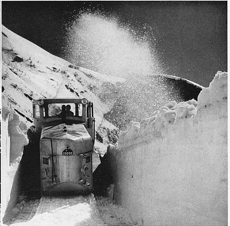
Unten: Die Schneeschleuder frißt sich durch die noch hoch auf der Straße liegende weiße Masse.
