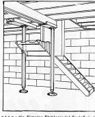
Unten: die Simplex-Stahlspindel-Sprießwinde wird direkt in die Holzkolonne eingebaut, um als permanente Spannvorrichtung zu dienen.
