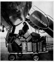
Links: Unter Anweisung eines Bordmechanikers, der den Ladeplan für Treibstoff und zahlende Last (Passagiere, Fracht und Post) erstellt, erfolgt der technisch einwandfreie Verlad des Gepäcks, der Fracht-und Postgüter. Die maximale Nutzlast beträgt rund sieben Tonnen.
