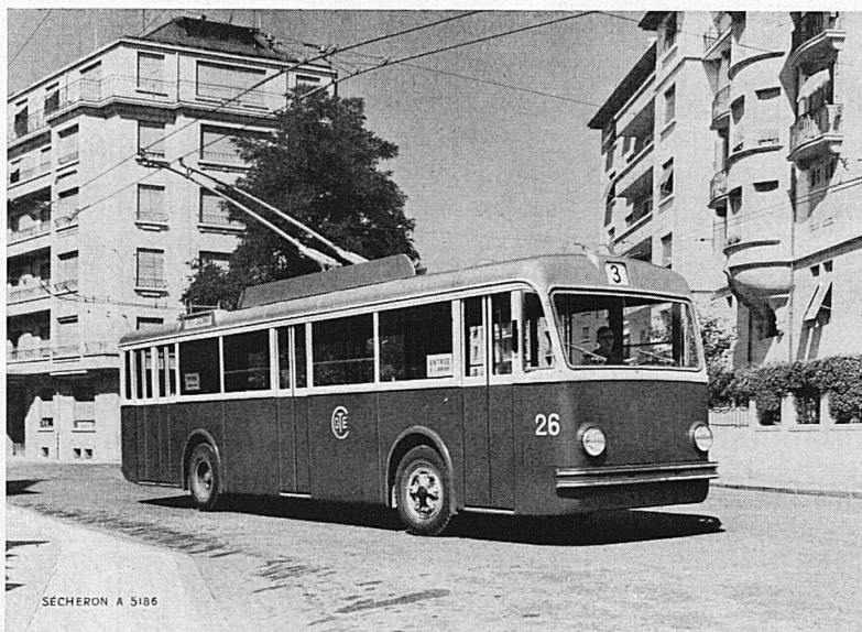
Compagnie Genevoise des Tramways Electriques: Un des 27 trolleybus modernes à grande capacité. Puissance: 130 ch. Vitesse maximum: 45 km/h.
