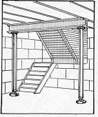
Unten: die Simplex-Stahlspindel-Sprießwind wird direkt in die Holzkolonne eingebaut, un als permanente Spannvorrichtung zu dienen
