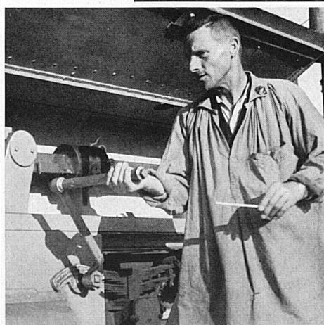
Gewichtsanzeige nicht um ein Kilogramm von dem auf den Eichkörpern verzeichneten Betrag abweichen. Ist die Eichprobe gut zu Ende gekommen, kann der Meßapparat seinen Dienst im großen Betrieb der Eisenbahn wieder für Jahre als zuverlässiges Präzisionsinstrument versiehen.
