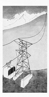
Ci-dessus: Principe de l'installation du nouveau téléphérique Crans—Cry d'Err, à cabines multiples. - Oben: Aufhängekonstruktion einer der Kabinen der neuen Luftseilbahn Crans—Cry d'Err.
