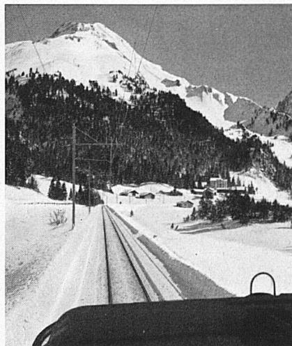
Links: Meterspur findet man auf den meisten und bekanntesten unserer Schmalspurlinien, so auf der ins Engadin führenden Rhätischen Bahn (siehe Bild), auf der Furka-Oberalp-Bahn, Visp-Zermatt-Bahn, der Brüniglinie der SBB, usw. – A gauche: Nos chemins de fer à voie étroite les plus connus mesurent pour la plupart 1 m. d'écartement, par exemple les chemins de fer rhétiques qui donnent accès au Haut-pays de l'Engadine.
