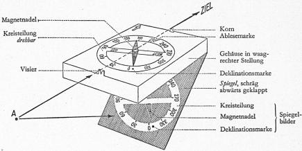
Oben: Messen des Richtungswinkels im Gelände mit einer Patent-Bussole. – Ci-dessus: En plein air, on mesure un angle de mire à l'aide d'une boussole brevetée.
