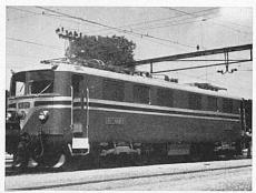
(20 000 Volt) in Betrieb genommen und dafür in der Schweiz das Antriebsmittel für die Züge herstellen lassen. Die von der Schweiz. Lokomotivfabrik in Winterthur und der Maschinenfabrik Oerlikon konstruierte Lokomotive CC-6051, die wir im Bilde vorführen, hat ein Eigengewicht von 104 Tonnen und vermag eine Last von 1350 Tonnen über Rampen von 25 0/00 zu schleppen.
