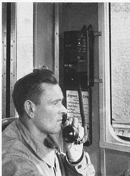
Das Zugstelephon auf dem Führerstand. Ein paar übersichtlich angeordnete Tasten und Lämpchen dienen zum Anrufen der Stationen oder Züge sowie zum Antworten.
