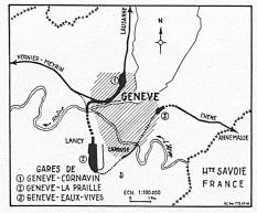
Ci-dessus: Projet des lignes de raccordement: Genève-Cornavin — Genève-Eaux-Vives et Vernier-Meyrin — Genève-La Praille. — Oben: Die Linienführung der neuen Genjer Verbindungsbahn, deren erstes Teilstück Genf-Hauptbahnhoj—Genf-La Praille vollendet ist.
