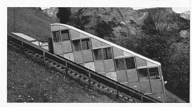
Oben: Wie die Wagenkasten anderer modernisierter Seilbahnen wurden auch diejenigen der Gerschnialpbahn in eleganter Leichtstahi-Konstruktion ausgeführt. — Ci-dessus: Comme les autres funiculaires modernisés, celui de la Gerschnialp a fait exécuter en acier léger les élégantes carrosseries de ses voitures. Photo: Meuser.
