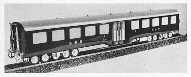
Oben: Modellaufnakme des «Schlieren»-Superleichtwagens auf Autopneus. — Ci-dessus: Maquette du nouveau wagon extra-léger «Schlieren» monté sur pneumatiques. Photo: Vetter.
