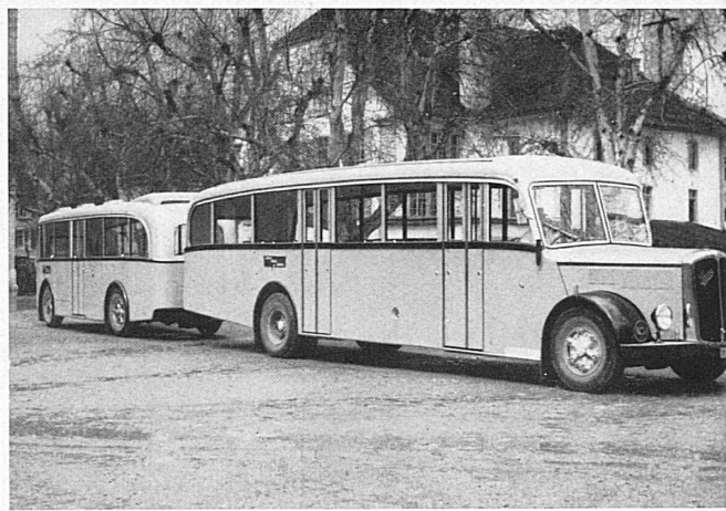
Oben: Auf der Linie Aarau—Frick über die Staffelegg im Jura setzte die PTT-Verwaltung einen neuen Kurswagen mit Anhänger ein, der 150 Passagiere zu befördern vermag. Der Zug ist 21 m lang und nach den modernsten Grundsätzen eingerichtet. — Ci-dessus: Les P. T. T. ont mis en service une nouvelle voiture à remorque capable de transporter 150 passagers. Photo: ATP.
