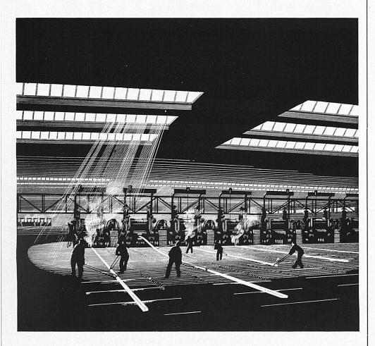
ie Halle des Walzwerks spannt sich breit und lang über eine weite Fläche aus stählernen Rollen und Platten. Quer durch die Halle hängt die Kommandobrücke, quer durch die Halle steht die Gruppe der Walzgerüste, die Walzenstraße. Am Kopf der Halle ist der mächtige Ofen gebaut, der die Stahlblöcke auf Weißglut erhitzen muß. Männer ziehen den Block mit langen Zangen aus dem Ofen und lassen ihn auf die «Fahrbahn», den Rollgang, gleiten.
