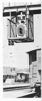
Vorrücksignal. Das über dem Hauptsignal aufgestellte Signal mit dem Kreuz und dem schrägen Lichtbalken hat nur für die Rangierzüge Gültigkeit. Das gemalte Kreuz allein bedeu
