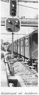
signal (entspricht dem mech. Durchfahrsignal) als Lichtsignale (entsprechend Bild 3). Mehr und mehr werden o mechanischen Signale durch Lichtsignale ersetzt. Diese zeigen am Tag und nachts gleiche Signalbilder, sind besonders bei Dämmerung und bei Nebel bedeutend besser sichtbar als die mechanischen und brauchen we-
