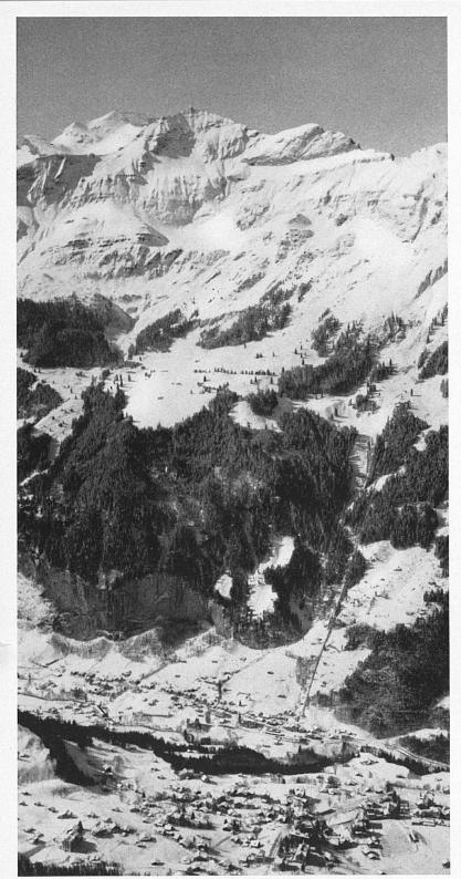
Links: Von Lauterbrunnen im Tal-grund führt die Drahtseilbahn (ge-Drahtseilbahn (gerader Strich) zur Grütschalp und von dort die elektrische Adhäsionsbahn nach links gegen Mürren.
