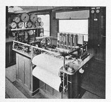
Inneres des SBB-Dynamometerwagens (Meßtisch, Streckenindikator und Stufenanzeiger).
