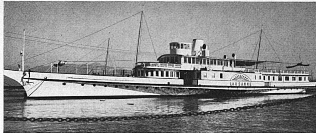
En haut: La flotte du Léman se modernise. Cinquante ans après son lancement, le « LAUSANNE » reprend le large, complètement rajeuni. Ses chaudières à vapeur ont fait place à une installation électrique, moteur Diesel, et le bateau a conservé sa ligne gracieuse.
