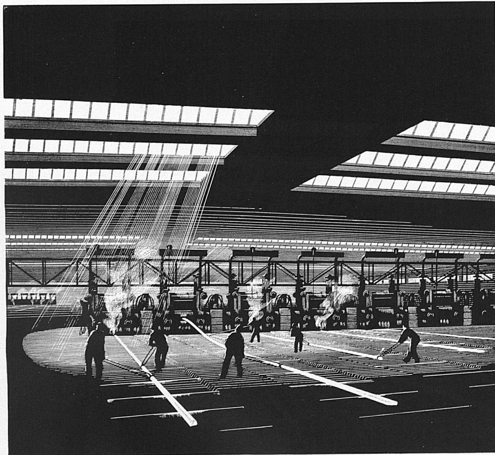
Die Halle des Walzwerks spannt sich breit und lang über eine weite Fläche aus stählernen Rollen und Platten. Quer durch die Halle hängt die Kommandobrücke, quer durch die Halle steht die Gruppe der Walzgerüste, die Walzenstraße. Am Kopf der Halle ist der mächtige Ofen gebaut, der die Stahlblöcke auf Weißglut erhitzen muß. Männer ziehen den Block mit langen Zangen aus dem Ofen und lassen ihn auf die «Fahrbahn», den Rollgang, gleiten.
