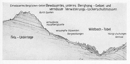
Schematisches Profil über die Entstehung von Rutschungen und Rüfen durch Schutthang-
